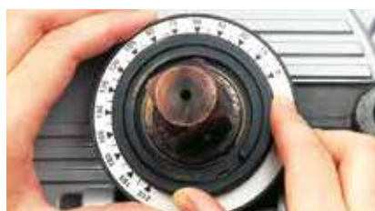
Regolazione dell'angolo di curvatura senza utensili
