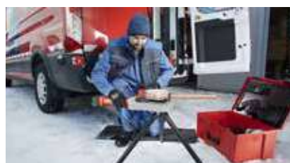
Regolazione dell'angolo di curvatura senza utensili
